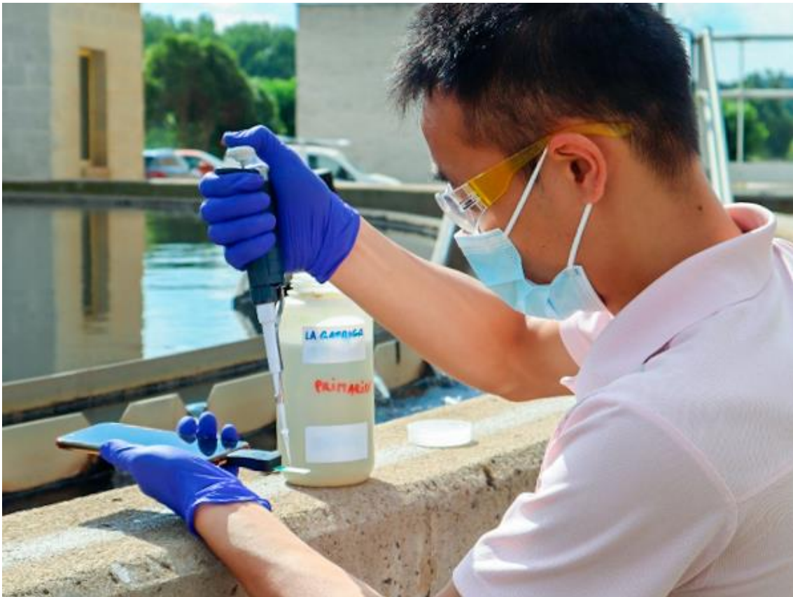
Wenchao Duan, investigador de l'ICMAB, fent servir el sensor electroquímic per analitzar els contaminants de l'aigua en una planta depuradora | ICMAB
